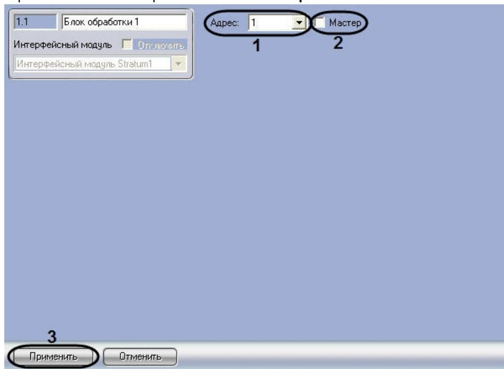
2. Из раскрывающегося списка **Адрес** выбрать локальный адрес процессорного модуля, заданный при настройке системы *Stratum* в программе «Site Manager» (1).
