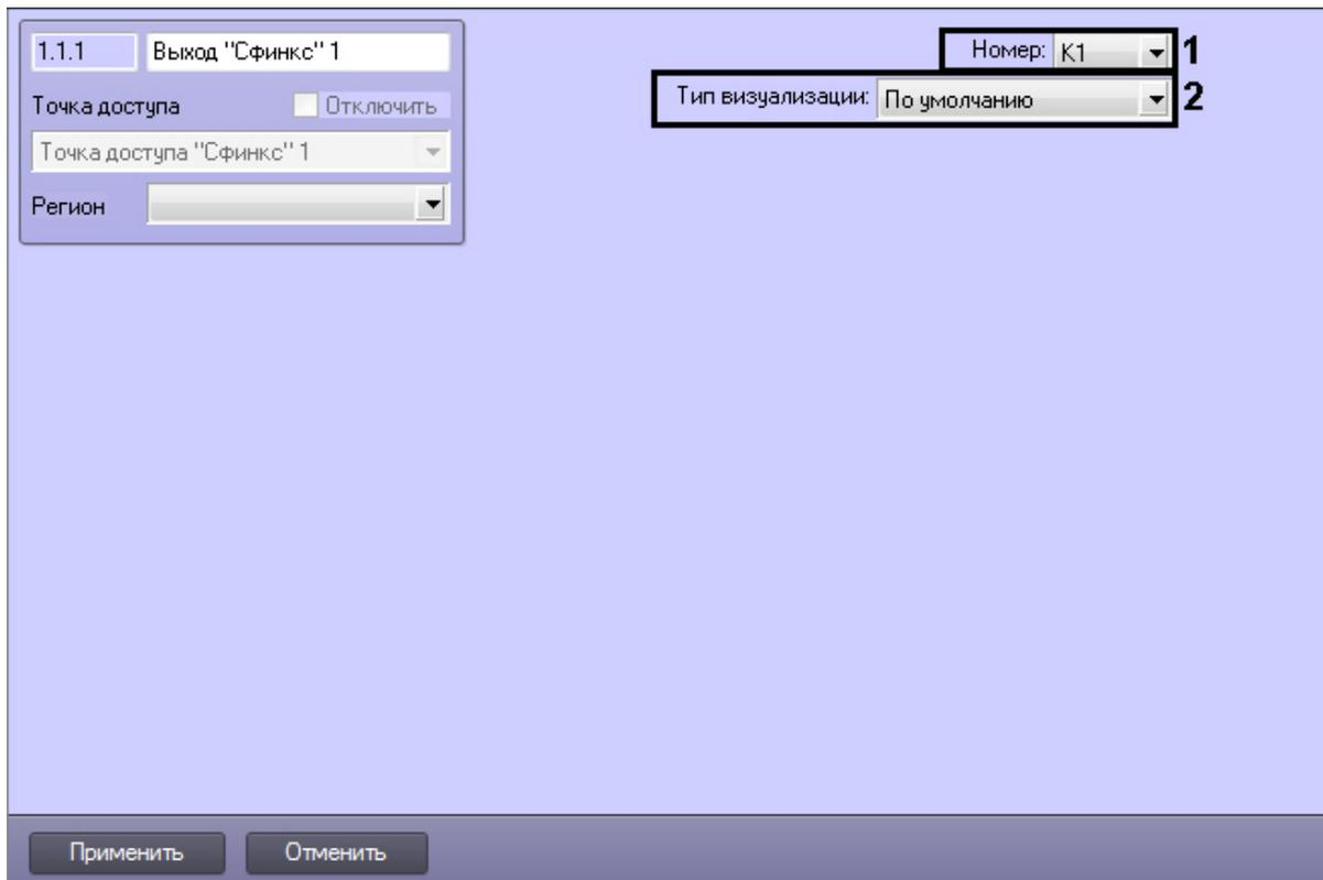
2. При чтении конфигурации *СКУД Сфинкс* автоматически определяется номер выхода (1).
