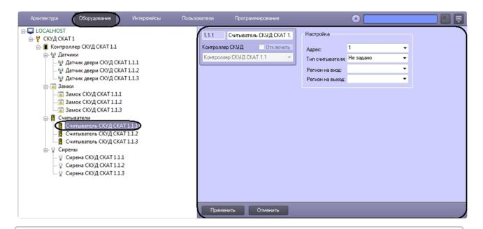
Объекты **Считыватель СКУД СКАТ** создаются при автоматическом построении дерева объектов (см. раздел Автоматическое построение дерева объектов СКУД «СКАТ»).
