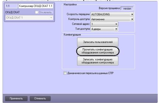
2. Нажать на кнопку Прочитать конфигурацию оборудования контроллера.
