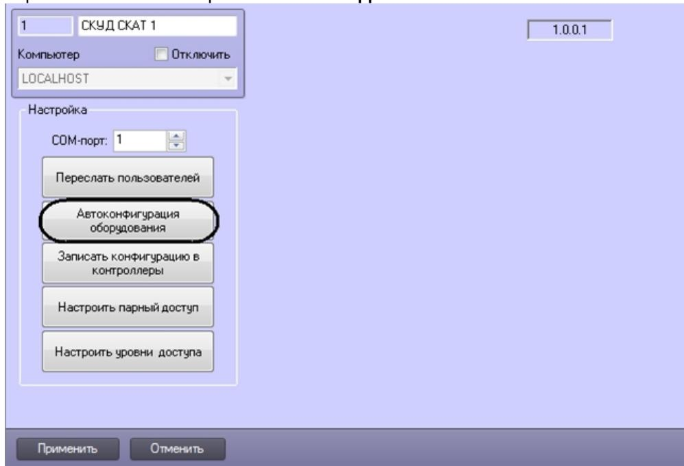
2. Нажать на кнопку **Автоконфигурация оборудования**.
