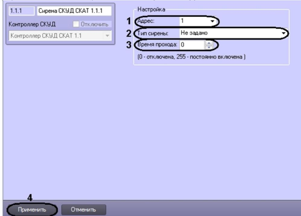
2. Из раскрывающегося списка **Адрес** выбрать аппаратный адрес подключенной сирены (1).
