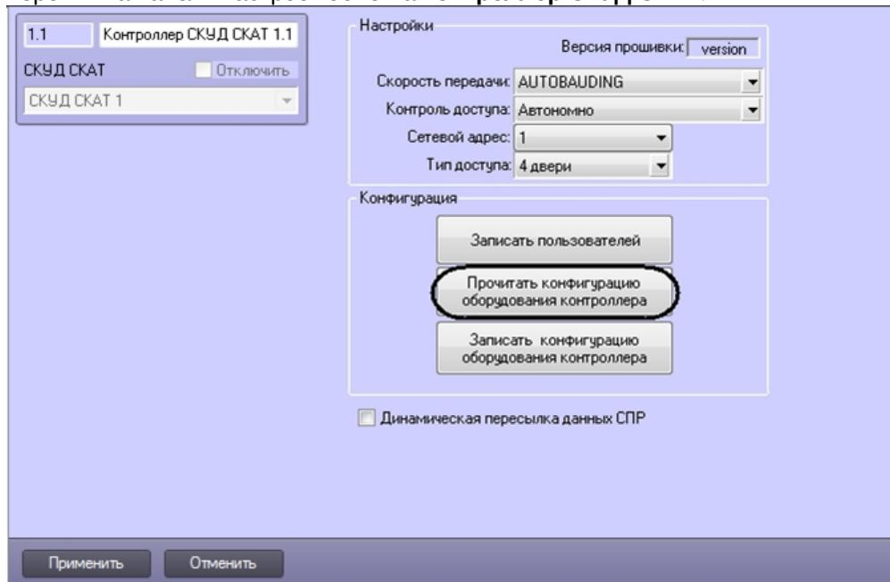
2. Нажать на кнопку **Прочитать конфигурацию оборудования контроллера**.
