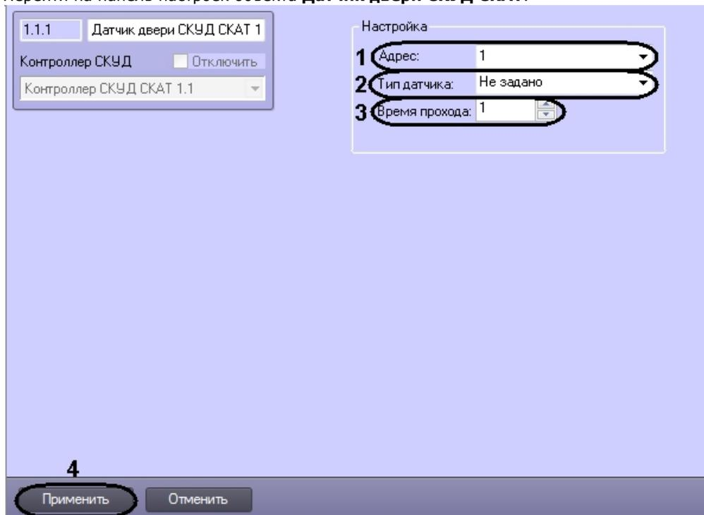
2. Из раскрывающегося списка **Адрес** выбрать аппаратный адрес подключенного датчика двери (1).
