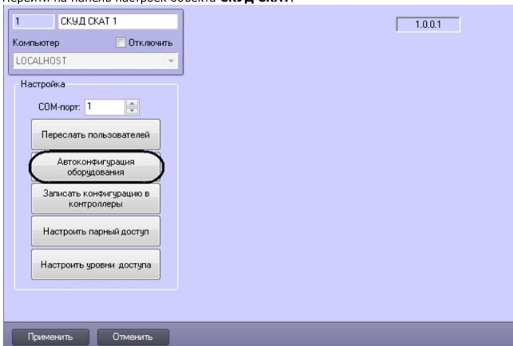
2. Нажать на кнопку **Автоконфигурация оборудования**.
