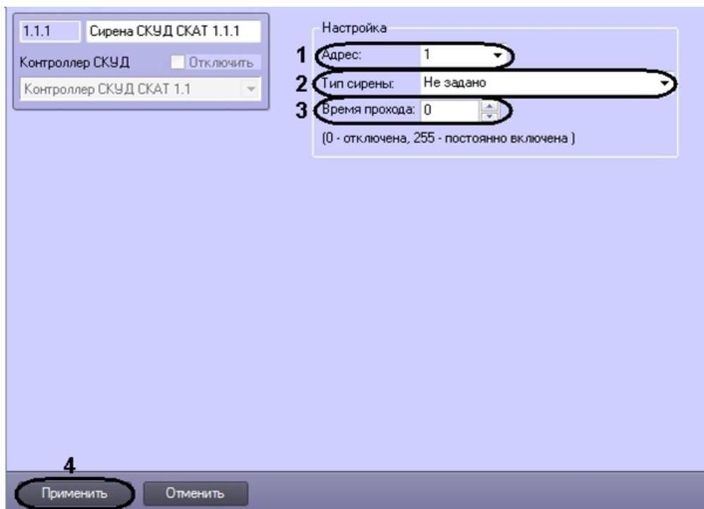
2. Из раскрывающегося списка **Адрес** выбрать аппаратный адрес подключенной сирены (1).
