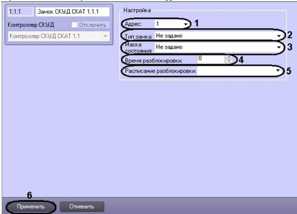
2. Из раскрывающегося списка **Адрес** выбрать аппаратный адрес подключенного замка (1).
