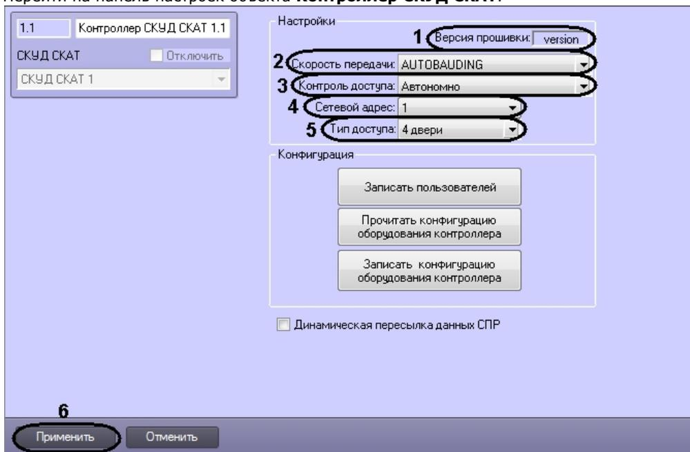
**Примечание.** В поле **Версия прошивки** отображается версия прошивки контроллера (1).
