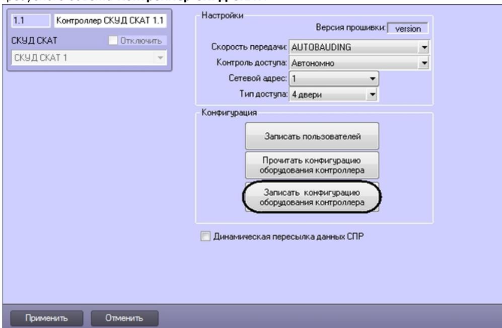
Для пересылки конфигурации оборудования в выбранный контроллер *СКАТ* необходимо нажать на кнопку **Записать конфигурацию оборудования контроллера**.
