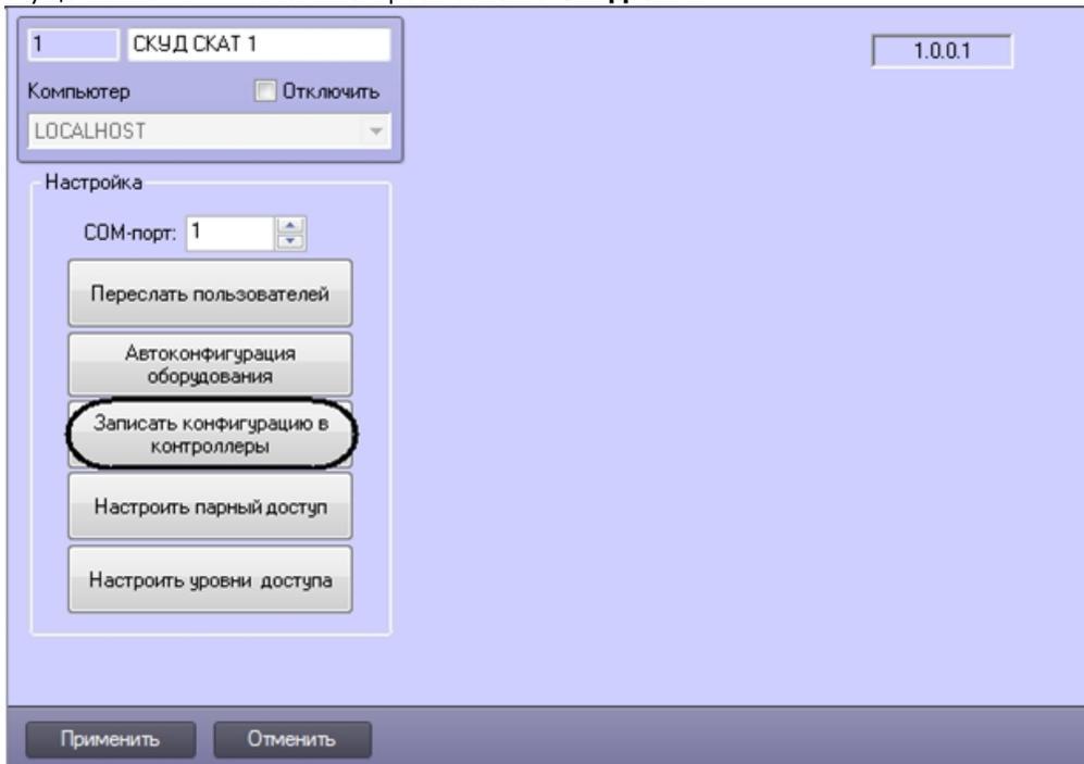
Для пересылки конфигурации в контроллеры *СКАТ* необходимо нажать на кнопку **Записать конфигурацию в контроллеры**.
