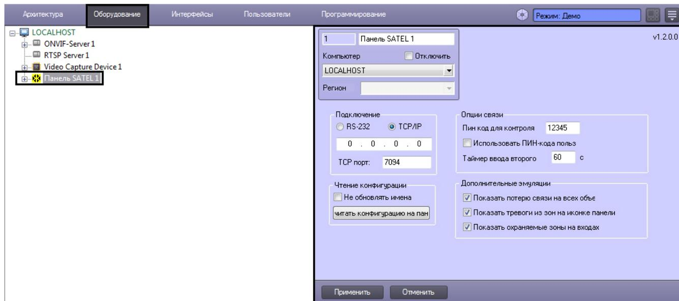
Панель может быть подключена к Серверу *ACFA Intellect* через интерфейсы RS-232 и Ethernet.
