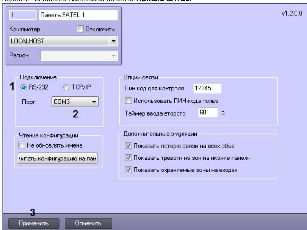
2. Установить переключатель в разделе **Подключение** в положение **RS-232** (1).
