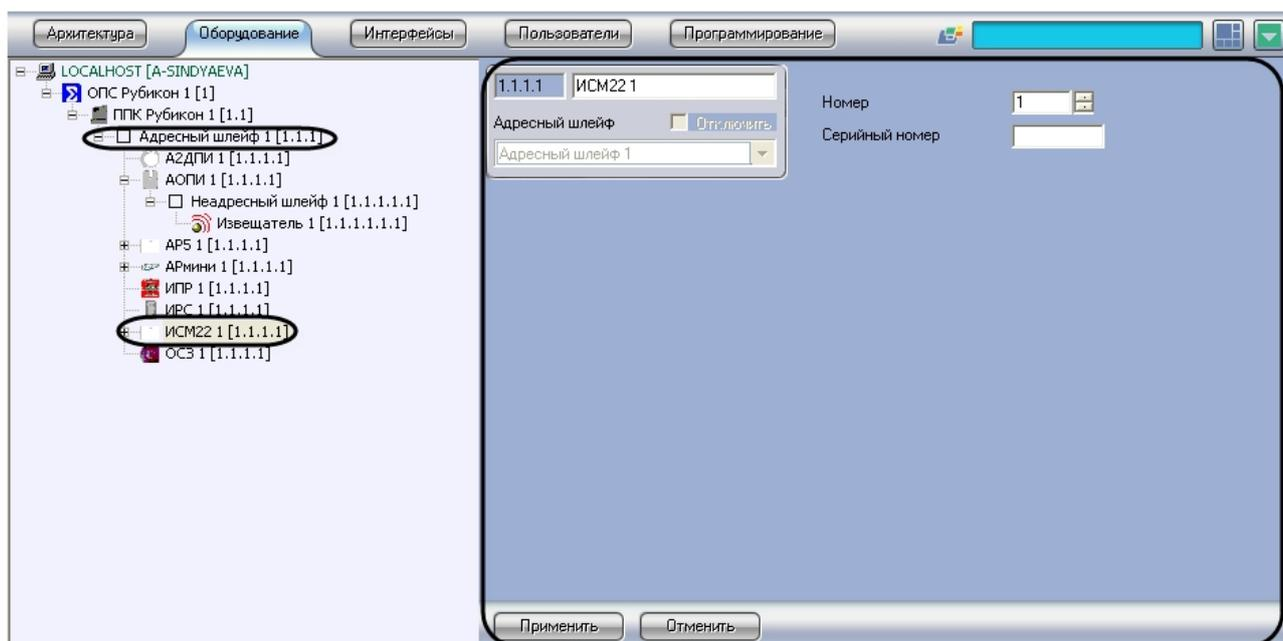
Настройка устройства *ИСМ22* проходит следующим образом:
