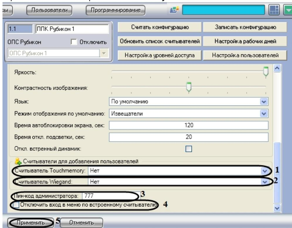
2. Из раскрывающегося списка **Считыватель Touchmemory**: необходимо выбрать считыватель, с которого будут присваиваться новые идентификаторы бесконтактных карт Touchmemory (1).
