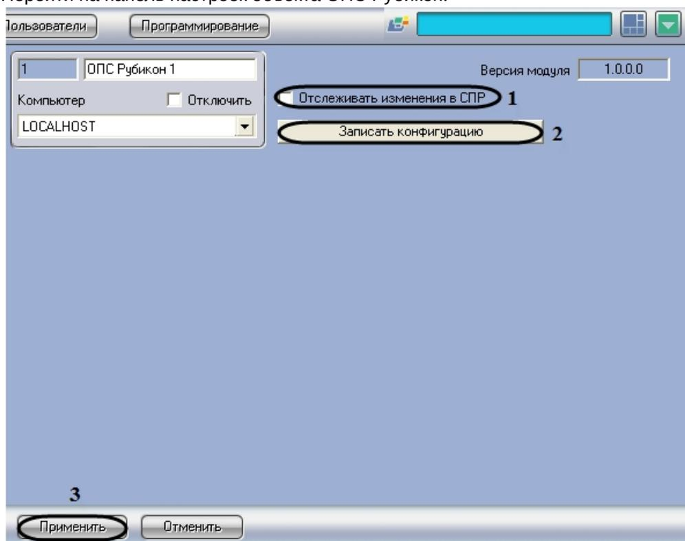
2. Установить флажок **Отслеживать изменения в СПР** для автоматической отправки изменений пользователей, временных зон и уровней доступа в устройства *ОПС Рубикон* (1).
