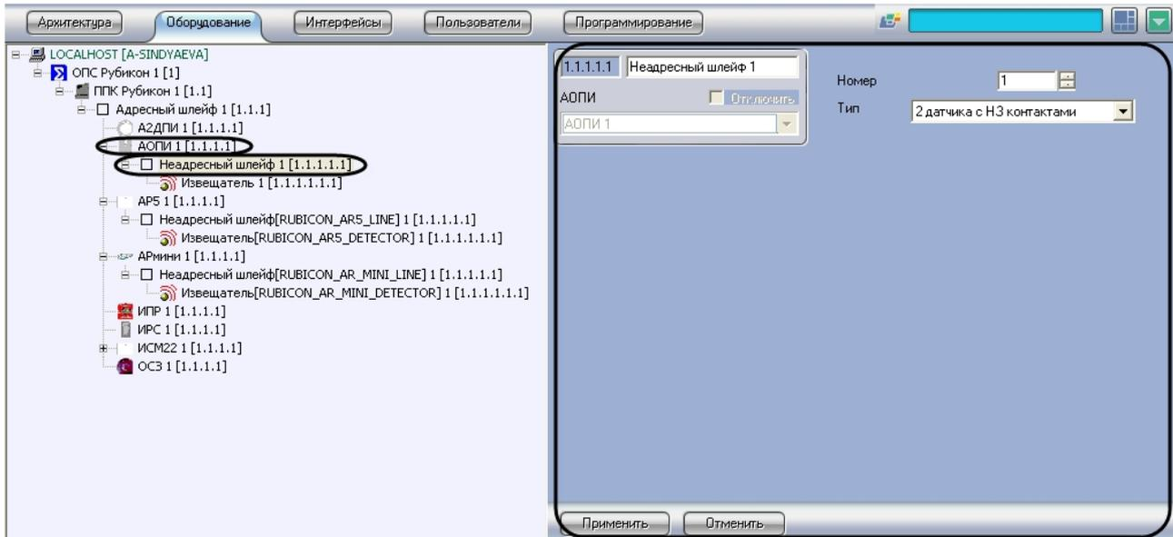
Настройка неадресных шлейфов проходит следующим образом:
