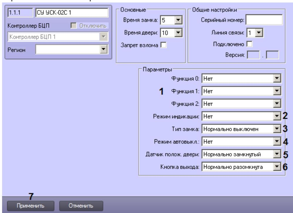
2. Из раскрывающихся списков **Функция** выбрать действия, выполняемые при нажатии на встроенные кнопки УСК (1).
