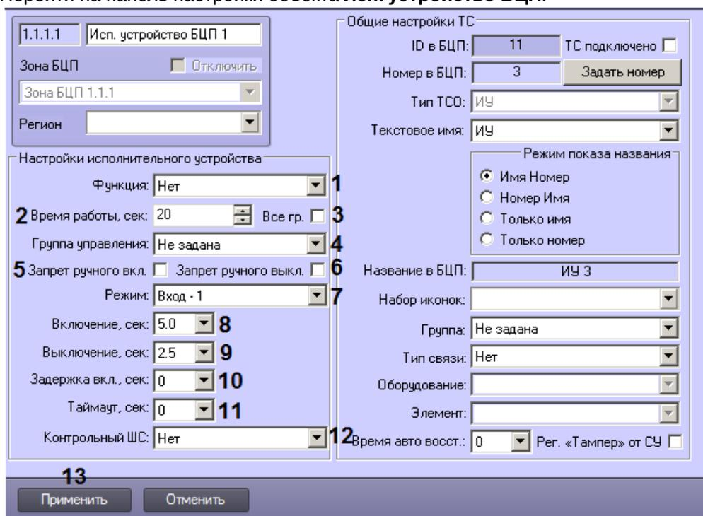
2. Из раскрывающегося списка **Функция** выберите функцию исполнительного устройства для автоматической работы совместно со шлейфом сигнализации (1). Подробнее о логике работы данного параметра см. документацию производителя.
