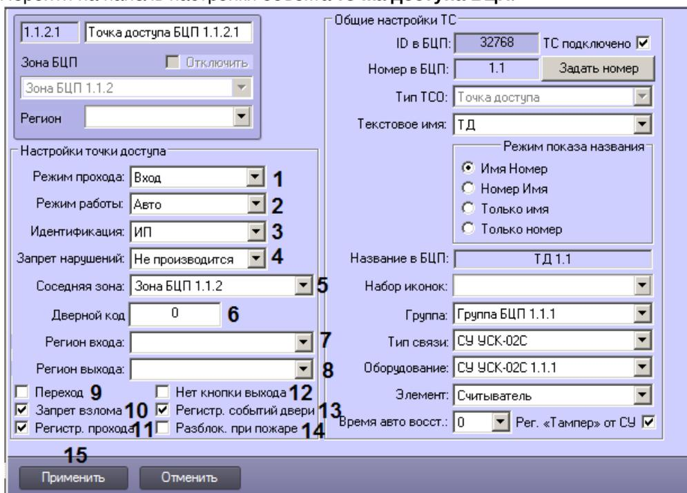
2. Из раскрывающегося списка **Режим прохода** выбрать направление прохода через точку доступа: вход или выход (1).
