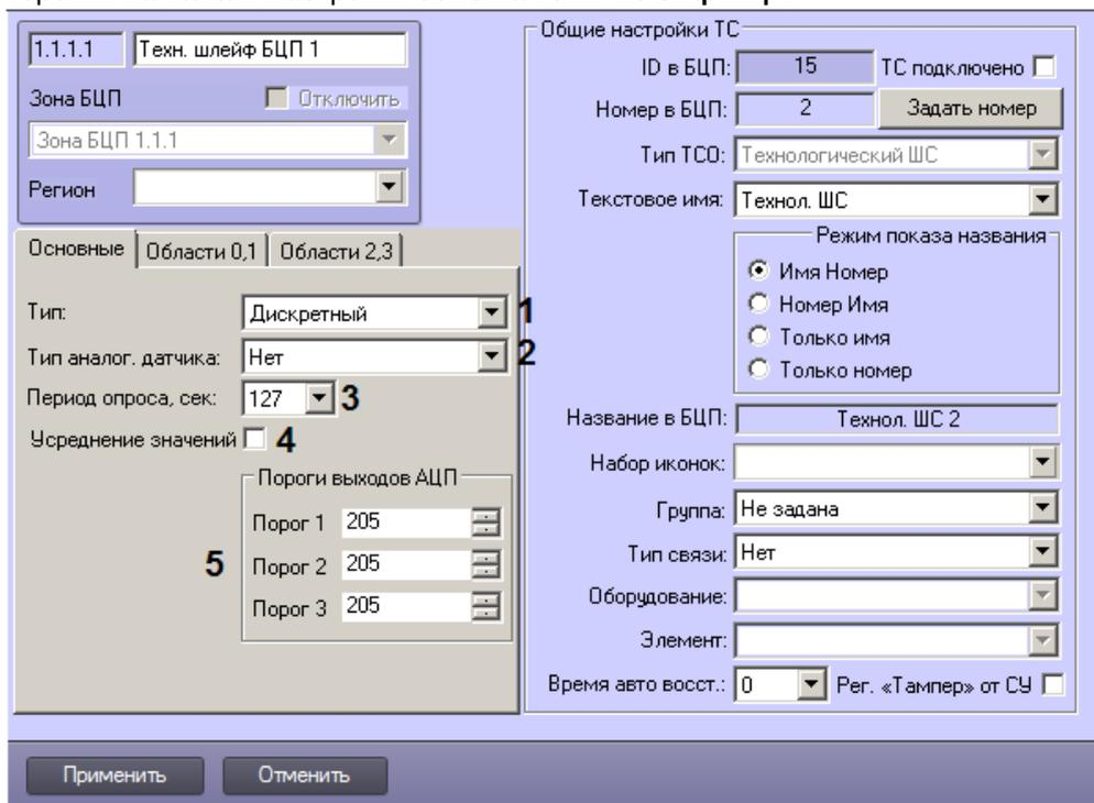
2. Из раскрывающегося списка **Тип** выбрать тип технологического ШС (1).
