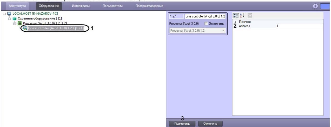
2. В поле **Address (2)** ввести адрес устройства **ПУНКТИР ЛК-С**, который указан в утилите производителя.
