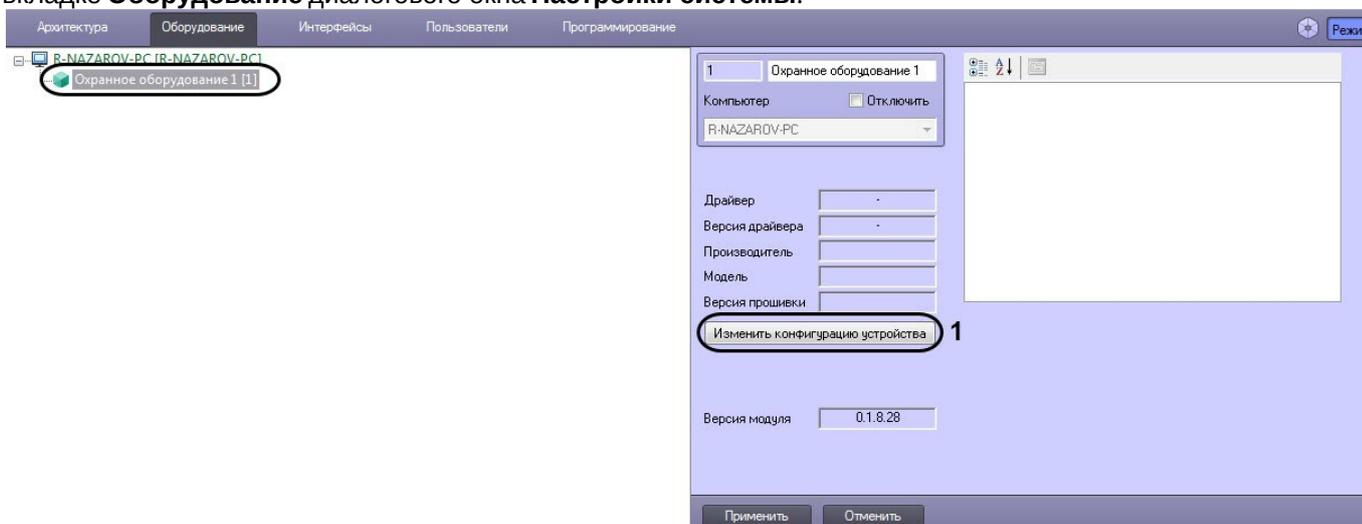
2. На панели настроек объекта **Охранное оборудование** нажать кнопку **Изменить конфигурацию устройства** (1).
