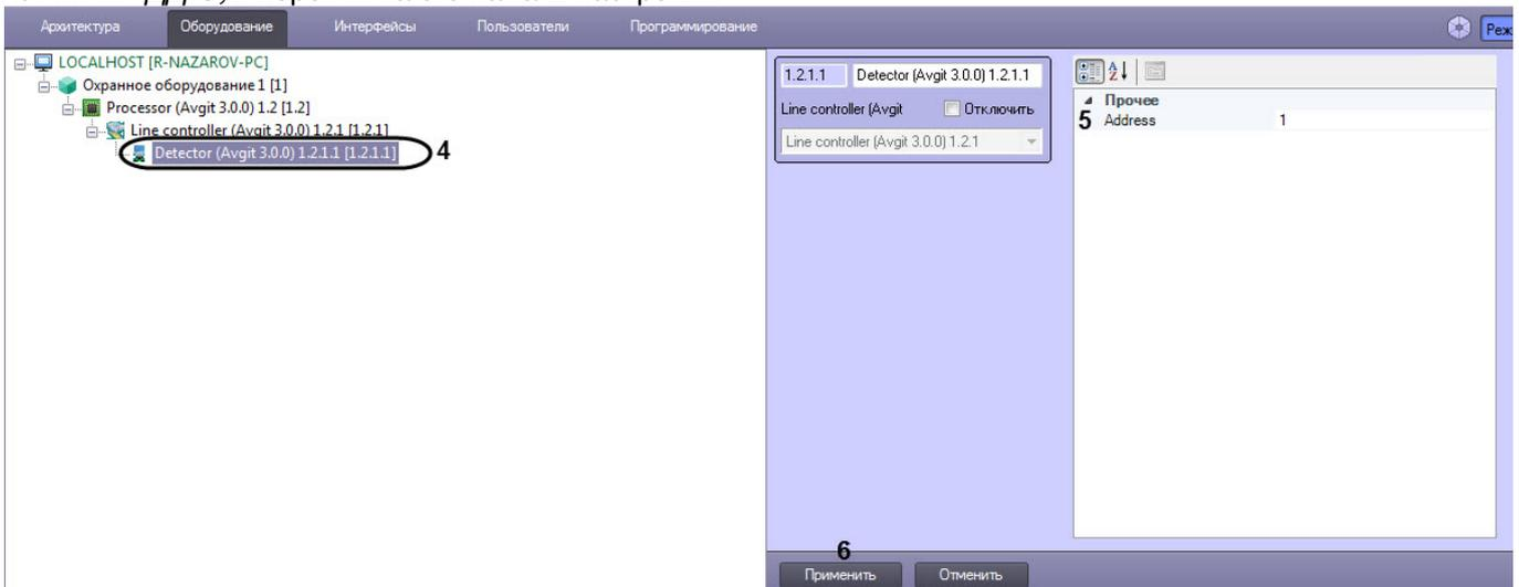
5. В поле **Address (5)** ввести адрес устройства **ПУНКТИР ДД-С**, который указан в утилите производителя.
