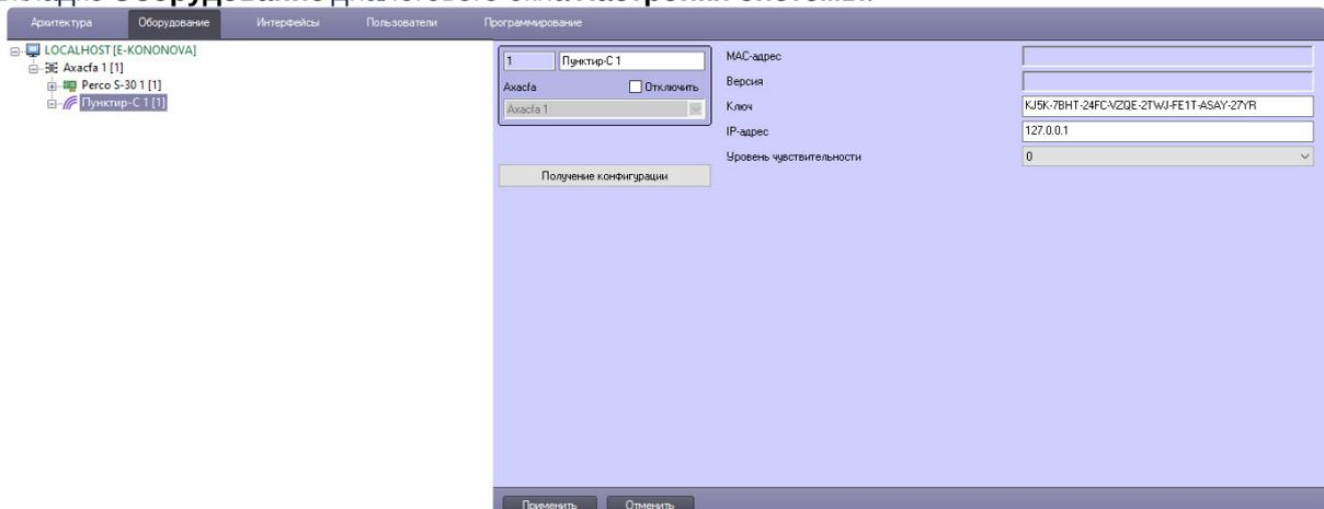
2. В поле **Ключ** ввести уникальный ключ доступа для подключения к устройству *Пунктир-С*, посмотреть который можно в настройках ПО производителя *Онлайн конфигуратор Пунктир-С*.
