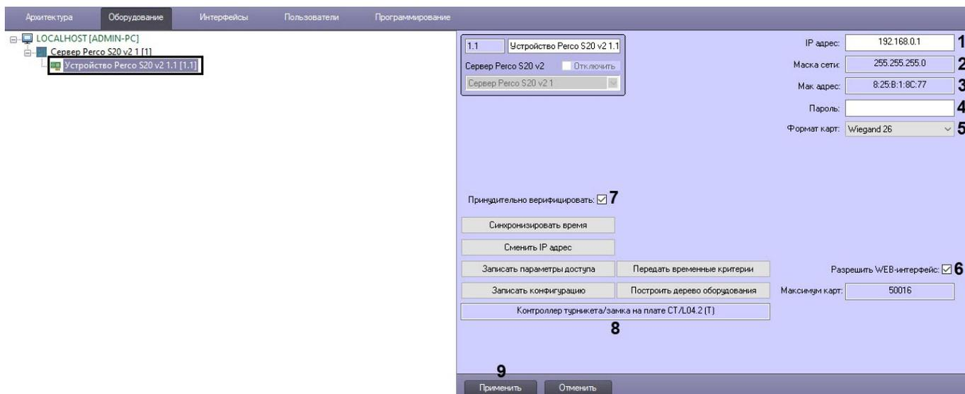
2. В поле **IP адрес** (1) ввести IP-адрес для подключения к устройству *PERCo-S-20 v.2*.
