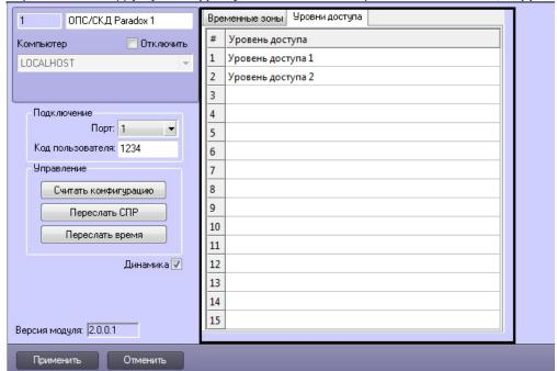
1. Перейти на вкладку **Уровни доступа** на панели настройки объекта **ОПС/СКД Paradox**.
