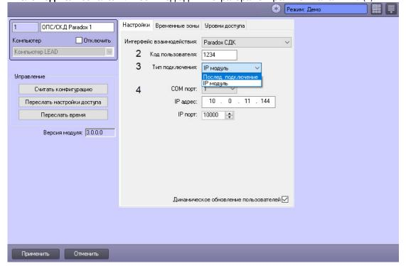
4. В поле **Тип подключения** из раскрывающегося списка выбрать нужный тип подключения: последовательное подключение или IP-модуль. При выборе последовательного подключения используется СОМ-порт. При выборе IP-модуля подключение происходит через модуль IP150 (3).
