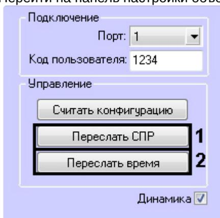
2. Для пересылки данных модуля *Служба пропускного режима* (пользователи, уровни доступа, временные зоны и т.д.) в контрольную панель EVO нажать кнопку **Переслать СПР** (1).
