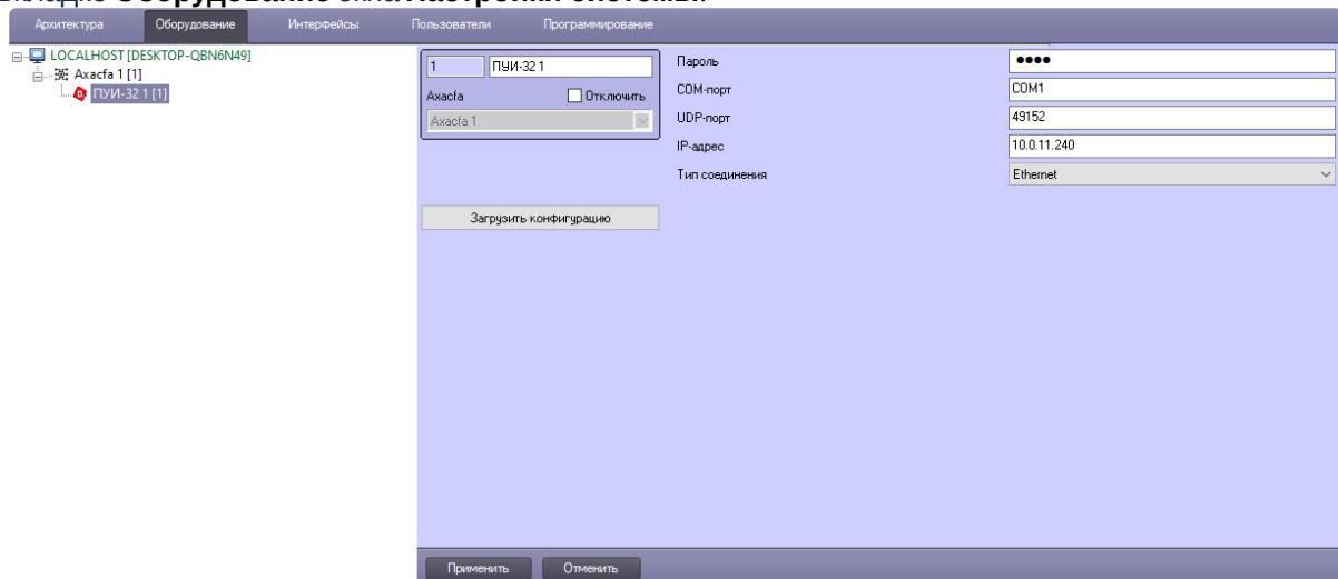
2. В поле **Тип соединения** выбрать, каким образом ПК Интеллект будет подключаться к прибору ПУИ-32: через **Ethernet** или **СОМ-порт**.
