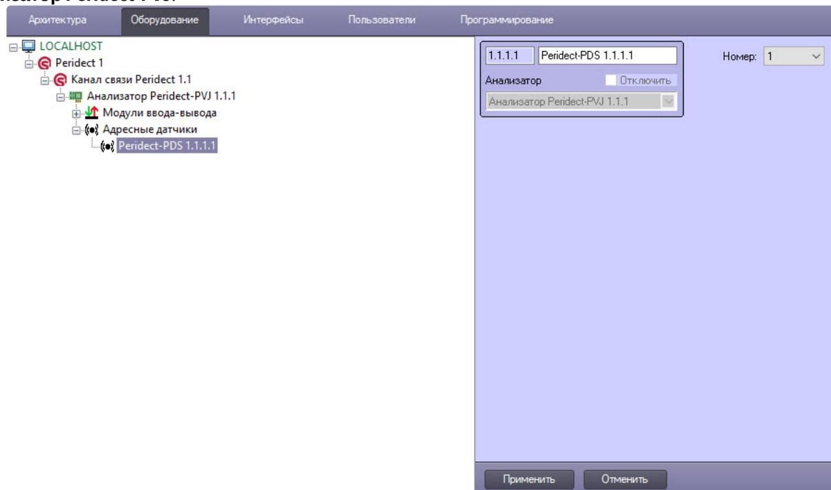
2. Из раскрывающегося списка **Номер** выбрать номер адресного датчика *PERIDECT* в пределах диапазона 1-246.
