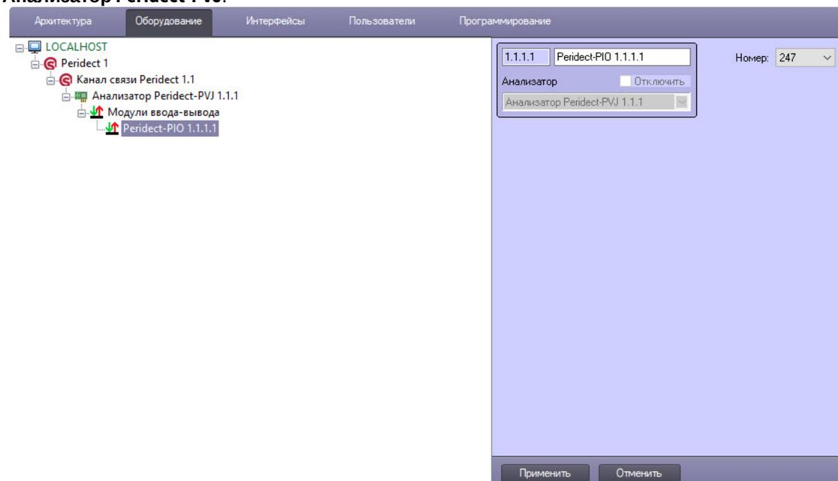
2. Из раскрывающегося списка **Номер** выбрать номер модуля входа и выхода *PERIDECT* в пределах диапазона 247-254.
