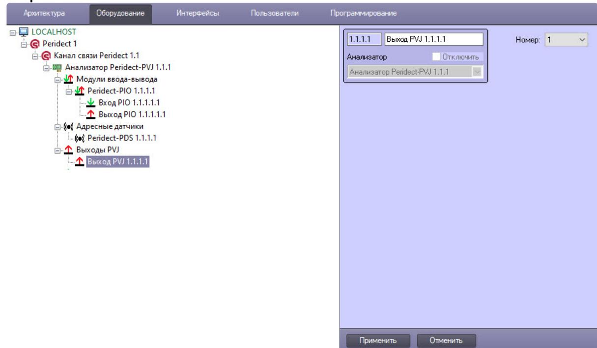
2. Из раскрывающегося списка **Номер** выбрать номер выхода анализатора *PERIDECT* в пределах диапазона 1-10.
