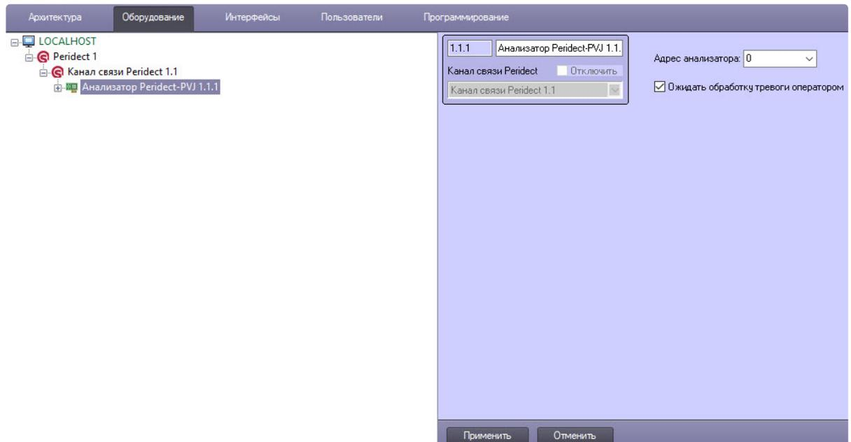
2. Из раскрывающегося списка **Адрес анализатора** выбрать адрес устройства в системе в пределах диапазона 0-15.
