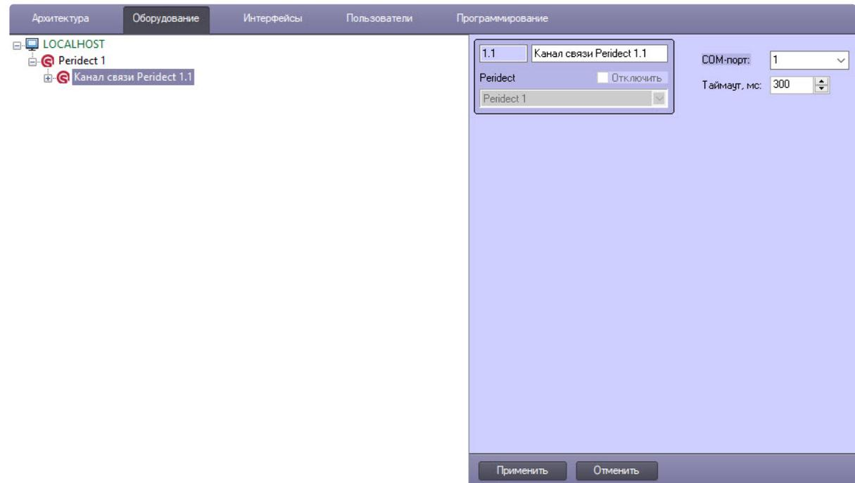
2. Из раскрывающегося списка **COM-порт** выбрать номер COM-порта для подключения устройства *PERIDECT*.
