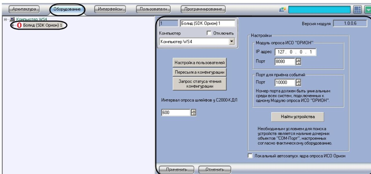
Настройка подключения Сервера *АСФА Intellect* к ядру опроса *ИСО Орион* производится следующим образом:
