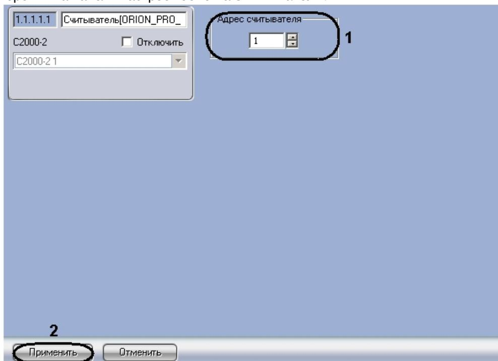
2. Указать текущий адрес считывателя в соответствующем поле (**1**). Адрес считывателя не должен совпадать с адресами реле, шлейфов и других считывателей, созданных на базе того же объекта, что и настраиваемый.
