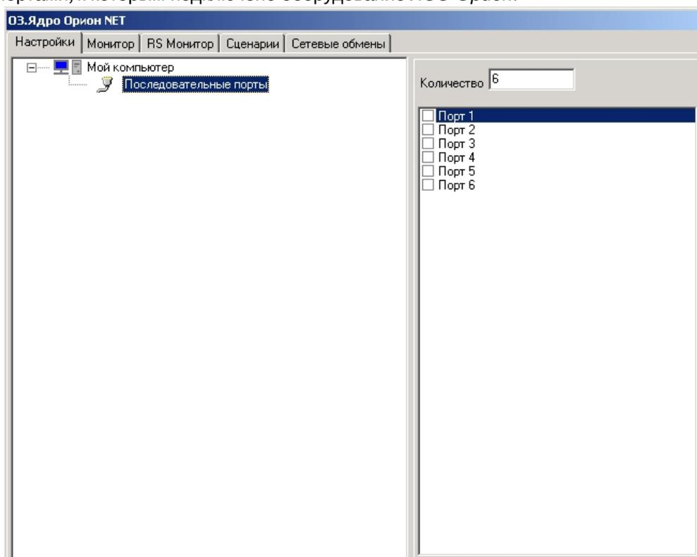
2. В дереве оборудования на базе объекта **COM** отображается подключенное через данный порт оборудование (**1**)
