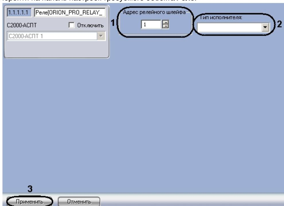
2. В поле **Адрес релейного шлейфа** ввести текущий адрес реле (1). Настоятельно не рекомендуется изменять адрес реле. В случае, если все же возникла такая необходимость, следует учитывать, что адрес релейного шлейфа не должен совпадать с адресами реле, шлейфов и считывателей, созданных на базе того же объекта, что и настраиваемый.
