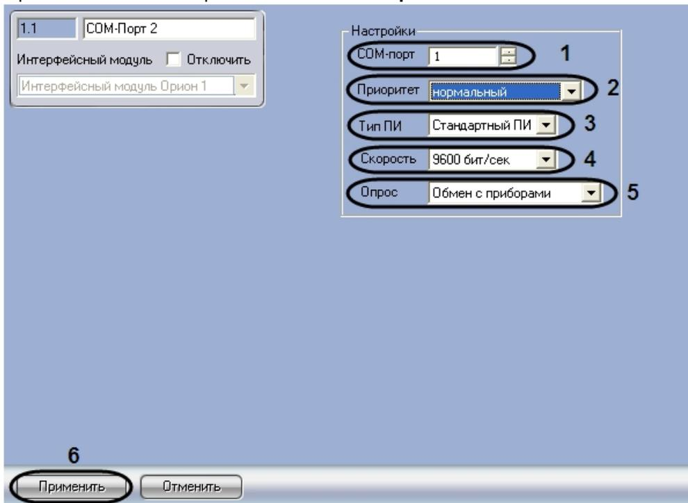
2. С помощью кнопок **вверх** - **вниз** установить номер СОМ-порта, к которому подключено оборудование *ИСО Орион* (1).
