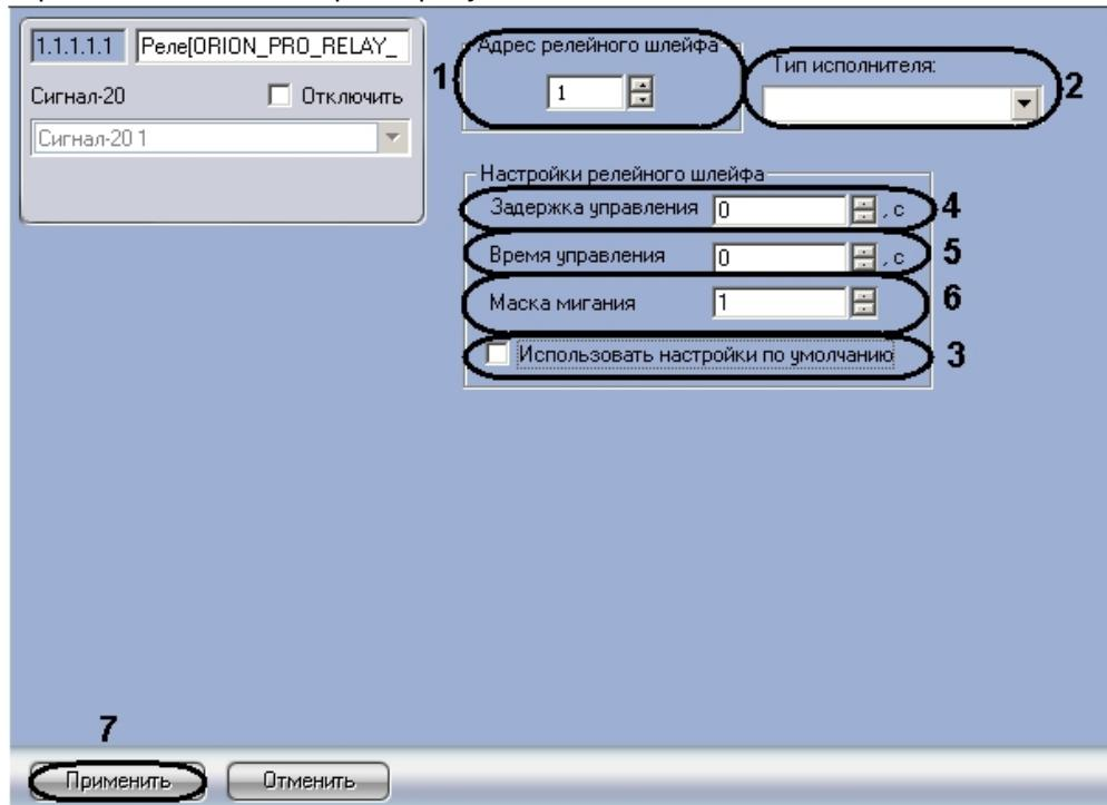
2. В поле **Адрес релейного шлейфа** ввести текущий адрес реле (1). Настоятельно не рекомендуется изменять адрес реле. В случае, если все же возникла такая необходимость, следует учитывать, что адрес реле не должен совпадать с адресами шлейфов, считывателей и других реле, созданных на базе того же объекта, что и настраиваемый.
