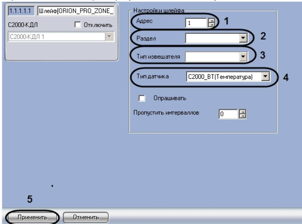
2. В поле **Адрес** введен текущий адрес шлейфа (1). Настоятельно не рекомендуется изменять адрес. Если такая необходимость все же возникла, следует задать адрес шлейфа таким образом, чтобы он не совпадал с адресами шлейфов, считывателей и других реле, созданных на базе того же объекта, что и настраиваемый.
