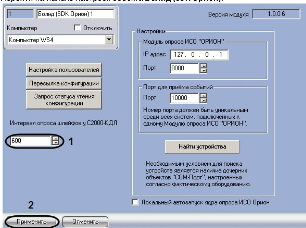
2. В поле **Интервал опроса шлейфов у C2000-КДЛ** ввести с помощью кнопок **вверх-вниз** интервал опроса шлейфов всех контроллеров *C2000-КДЛ*, зарегистрированных в системе, в миллисекундах (1).
