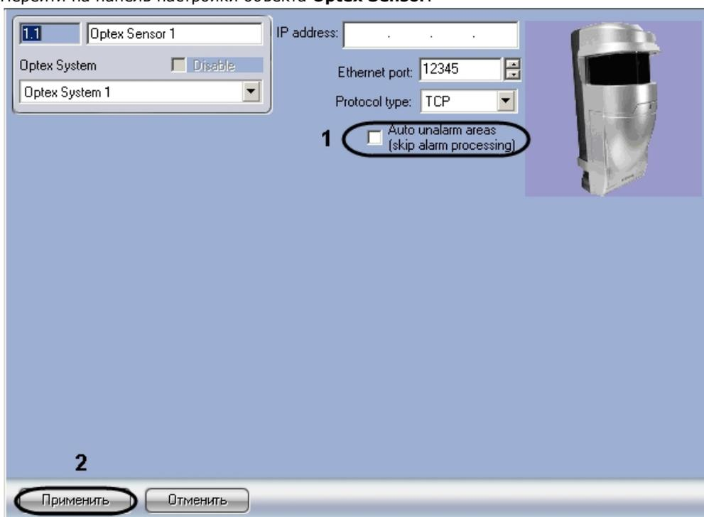
2. В случае, если тревогу со всех зон датчика требуется обрабатывать автоматически, необходимо установить флажок **Auto unalarm areas (pass process alarm)** (1). В случае, если обработка тревоги со всех зон датчика должна производиться оператором, данный флажок необходимо снять.
