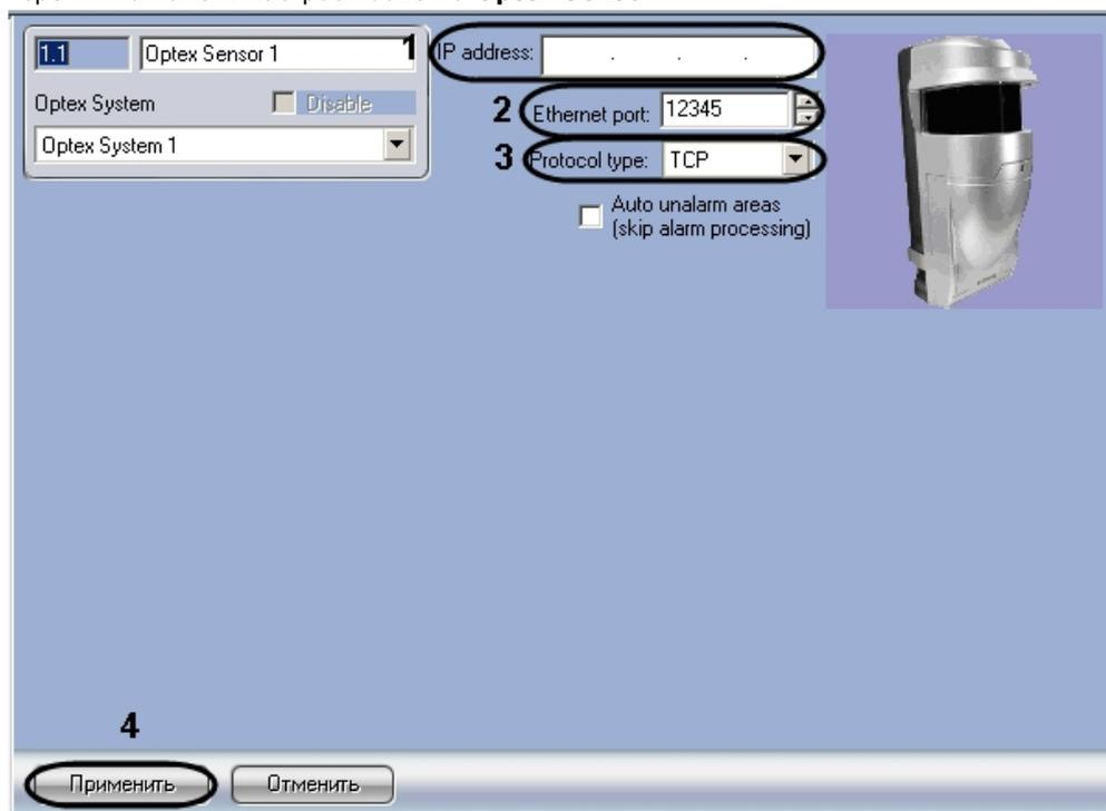
2. В поле **IP-address** указать IP-адрес датчика (1).
