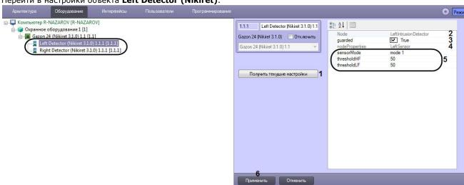
2. Нажать на кнопку **Получить текущие настройки (1)**, чтобы считать текущие настройки с устройства *Газон-24*.
