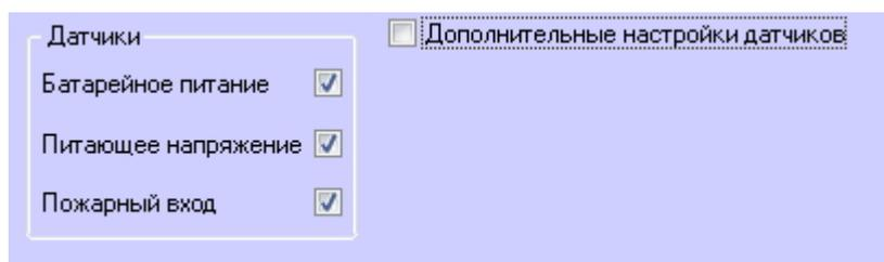
Устанавливая или снимая соответствующие флаги, можно включать и отключать датчики батарейного питания, питающего напряжения и пожарного входа.
