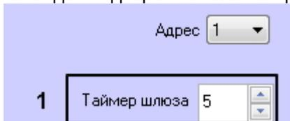
2. В секции **Конф-ция точки прохода** в поле **Таймер замка** ввести время в секундах, в течение которого замок двери открыт (2).
