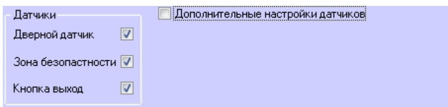
Устанавливая или снимая соответствующие флаги, можно включать и отключать датчики двери, зоны безопасности и кнопки "Выход".
