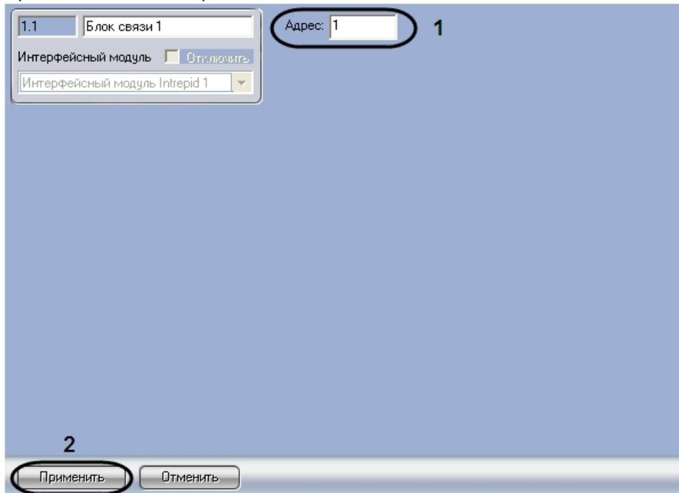
2. В поле **Адрес** ввести адрес модуля связи, заданный при настройке системы *Intrepid Micropoint* в программе «Site Manager» (1).
