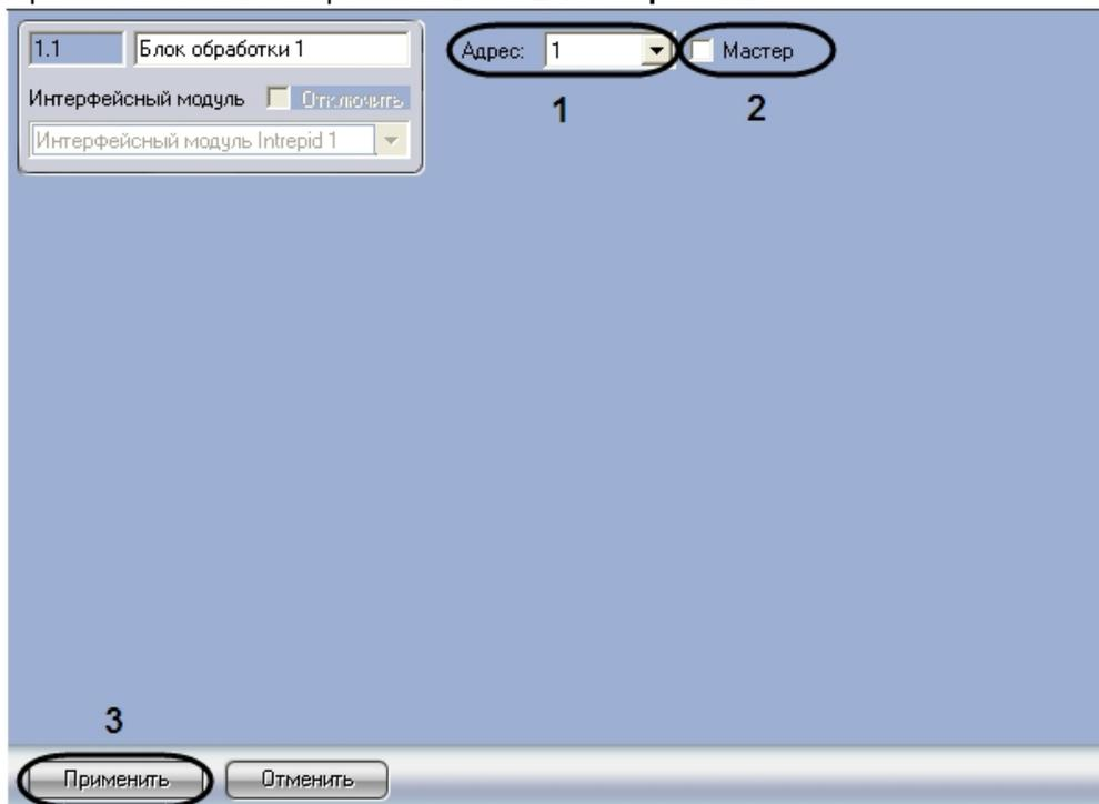
2. Из списка **Адрес** выбрать локальный адрес процессорного модуля, заданный при настройке системы *Intrepid Micropoint* в программе «Site Manager» (1).
