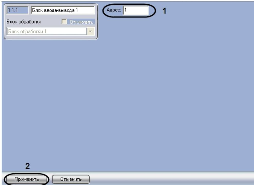
2. В поле **Адрес** ввести адрес релейного модуля *Intrepid Micropoint*, заданный при настройке системы *Intrepid Micropoint* в программе «Site Manager» (1).
