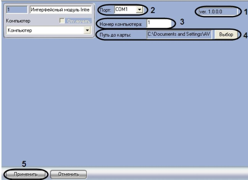
2. В поле 1 отображается версия программного модуля *Intrepid*.
