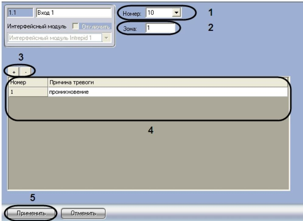
2. Из раскрывающегося списка **Номер** выбрать номер входа, заданный при настройке системы *Intrepid Micropoint* (1).
