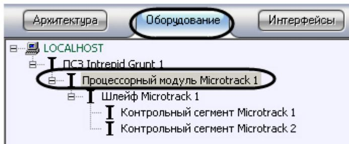
После создания объекта на его панели настроек будет отображена информация о подключенном процессорном модуле *Microtrack*.
