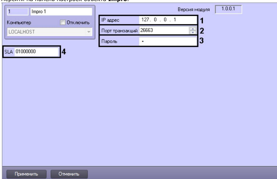
2. В поле **IP адрес** ввести IP адрес компьютера, на котором установлено программное обеспечение *СКД Impro* (**1**).
