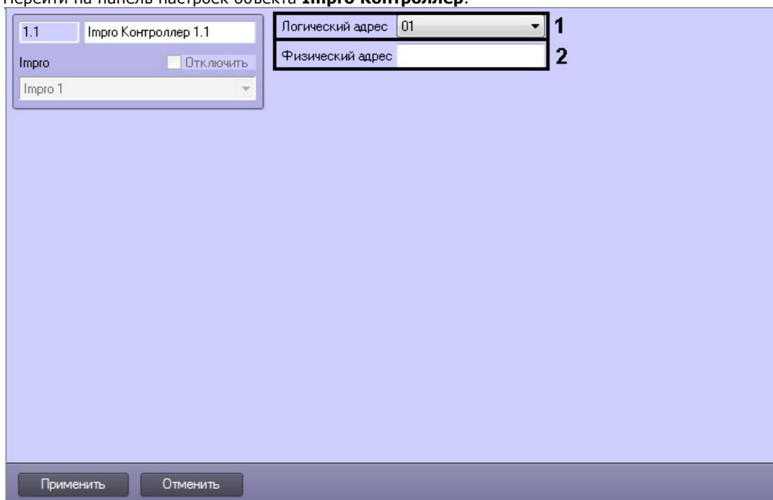
2. Из раскрывающегося списка **Логический адрес** выбрать логический адрес контроллера, указанный при конфигурировании оборудования в программном обеспечении производителя (**1**).
