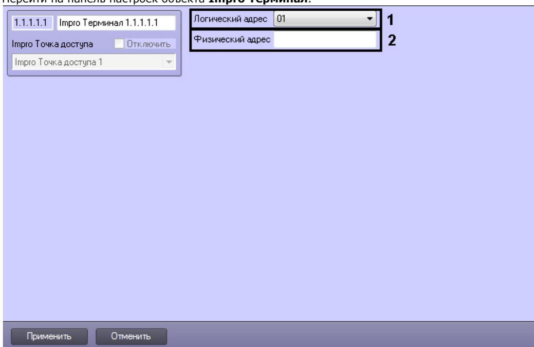
2. Из раскрывающегося списка **Логический адрес** выбрать логический адрес терминала, указанный при конфигурировании оборудования в программном обеспечении производителя (1).
