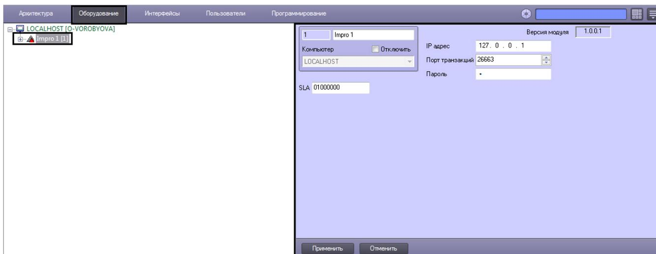
Настройка подключения СКД *Impro* к ПК *ACFA Intellect* осуществляется следующим образом:
