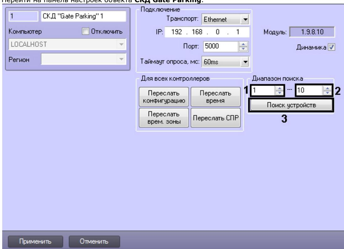
2. Указать диапазон адресов контроллеров следующим образом: первый адрес в поле **с:** (1) и последний адрес в поле **по:** (2).
