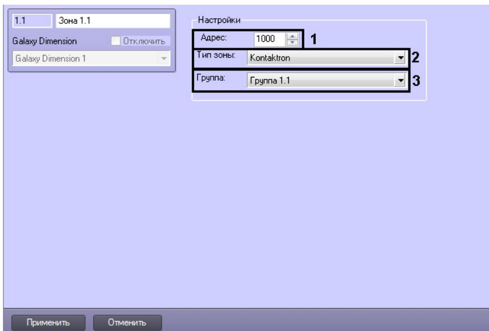
2. В поле **Адрес** ввести с помощью кнопок **вверх-вниз** адрес, отображаемый для данной охранной зоны в меню инженера контрольной панели *Honeywell Galaxy Dimension* (1).
