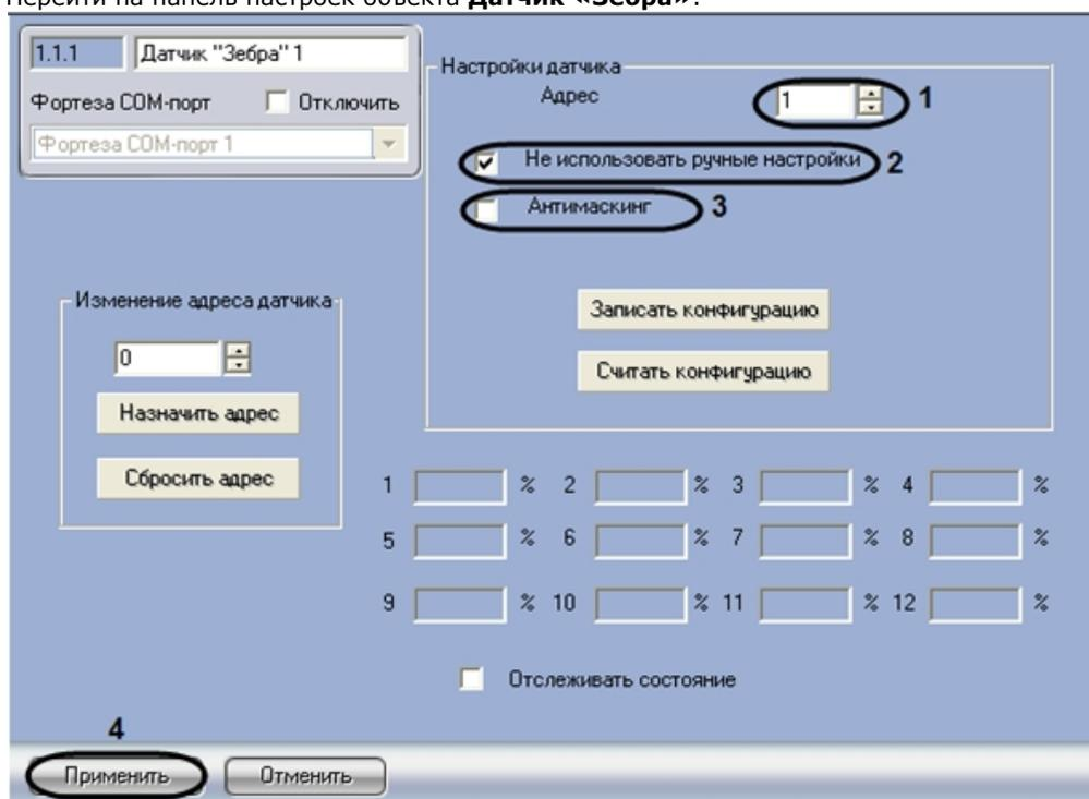
2. В поле **Адрес** отображается аппаратный адрес подключенного датчика *Земля* (1). Адрес считывается из устройства при автоматическом построении дерева объектов. Для изменения адреса следует воспользоваться группой **Изменение адреса датчика** (см. раздел *Изменение адреса датчика ПСЗ Фортеза*).
