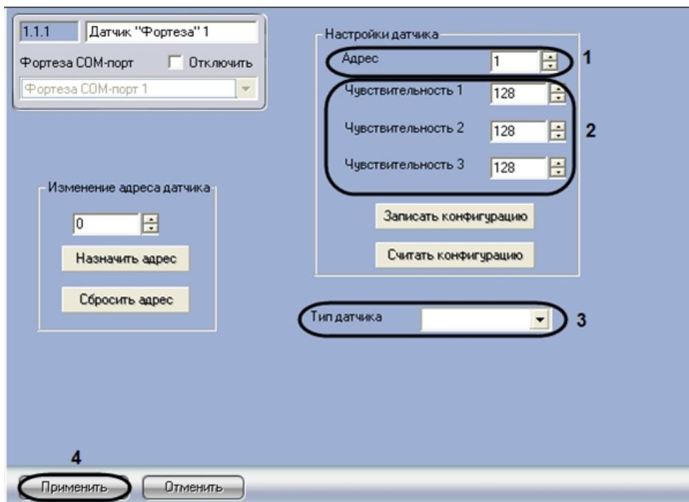
2. В поле **Адрес** указан аппаратный адрес датчика *Фортеза* (1). Адрес считывается из устройства при автоматическом построении дерева объектов. Для изменения адреса следует воспользоваться группой **Изменение адреса датчика** (см. раздел [Изменение адреса датчика ПСЗ Фортеза](#)).
