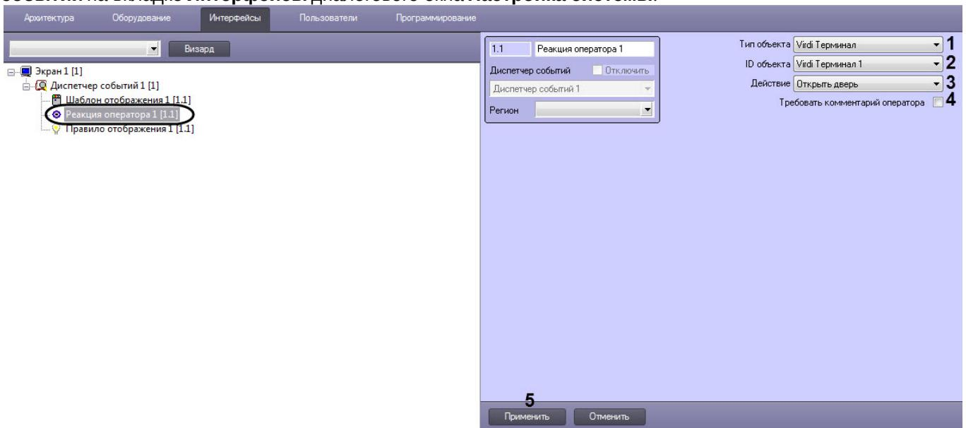
2. Из раскрывающегося списка **Тип объекта (1)** выбрать тип объекта, на который будет послана реакция при нажатии программной кнопки.
