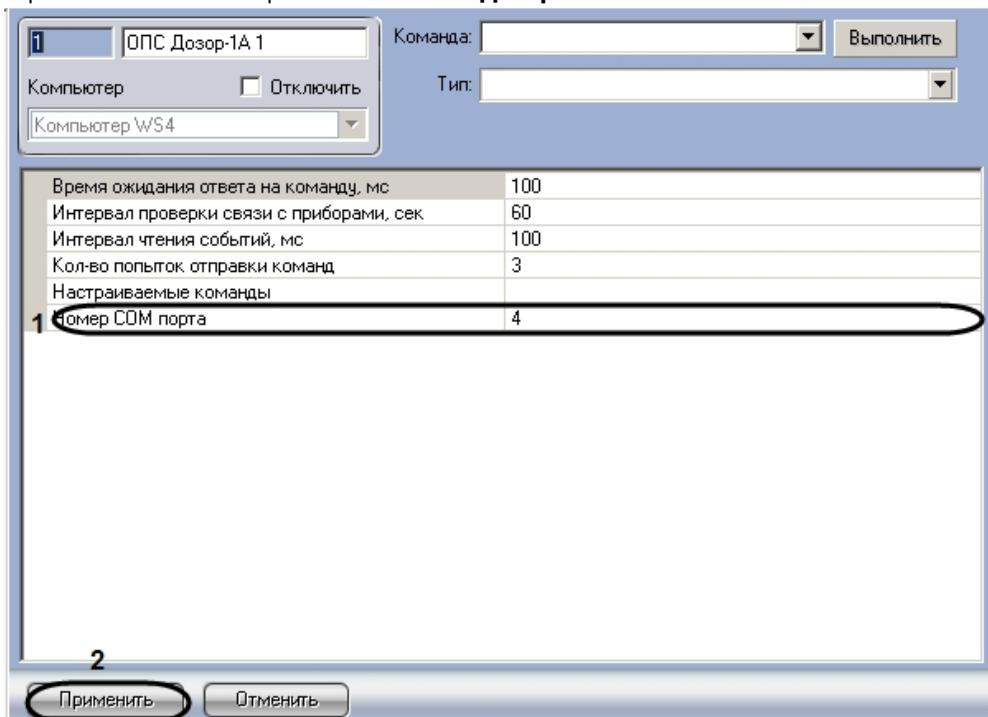
2. В поле **Номер СОМ-порта** ввести номер СОМ-порта подключения устройств *ОПС Дозор-1А* к Серверу (**1**).
