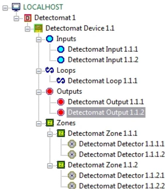
Физически детекторы подключены и располагаются на ветви устройств, но в программном комплексе *ACFA Intellect* о бъекты **Detectomat Detector** следует распределить по охранным зонам так, как это сделано в программном обеспечении производителя.
