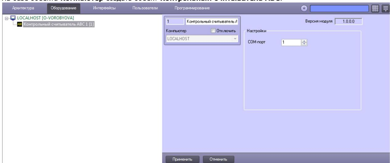
2. На панели настроек данного объекта выбрать номер COM-порта, который используется для подключения к контрольному считывателю.
