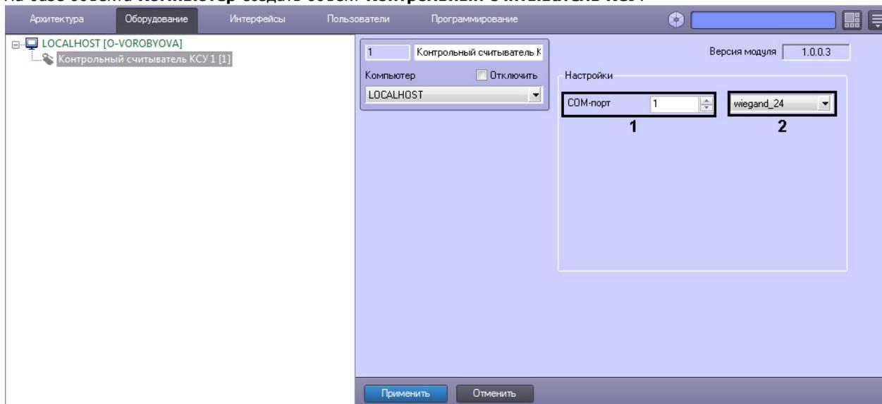
2. В поле **COM-порт** указать номер COM-порта, который используется для подключения к контрольному считывателю (1).
