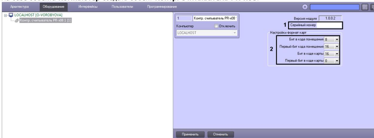
2. В поле **Серийный номер** ввести серийный номер контрольного считывателя (1).
