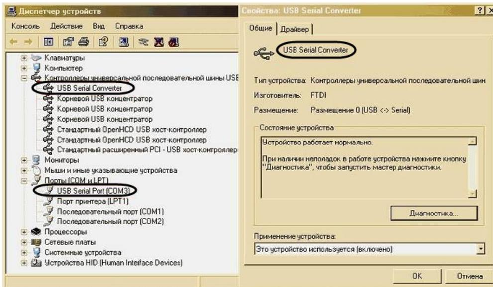
Номер COM-порта указывается в соответствии с номером, присвоенным ему при установке драйвера считывателя.
