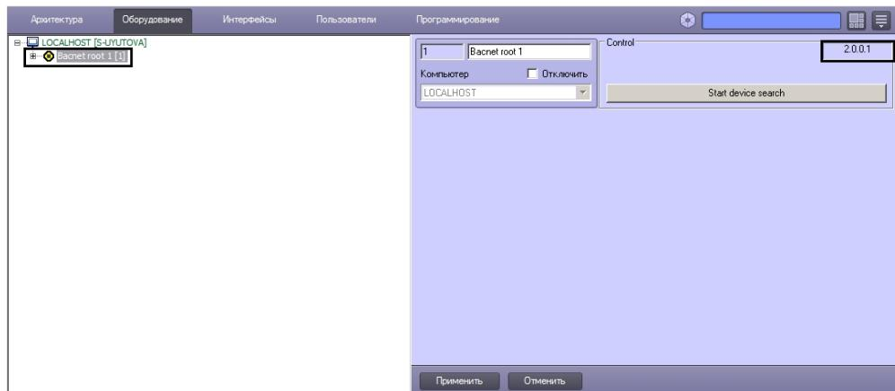
В поле в правом верхнем углу отображается версия модуля интеграции *BACnet Wrapper*.
