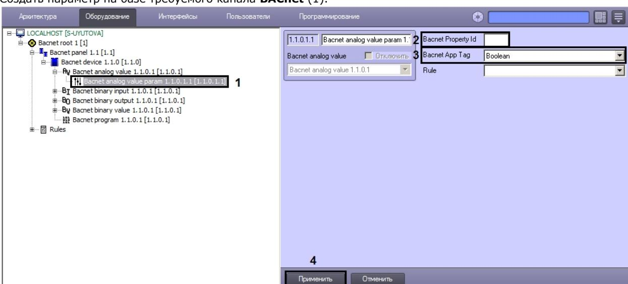
2. В поле **Bacnet Property Id** ввести идентификатор параметра канала, определенный протоколом или производителем устройства (2).
