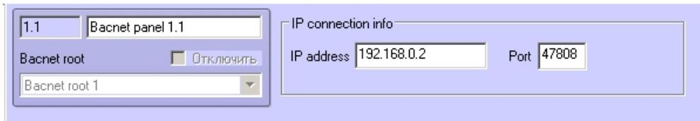
2. На панели настройки объекта **Bacnet device** отображается информация о найденном устройстве.
