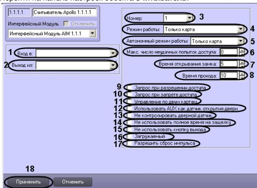
2. Из раскрывающегося списка **Вход в:** выбрать объект **Раздел**, соответствующий территории, расположенной со стороны выхода через считыватель (1).
