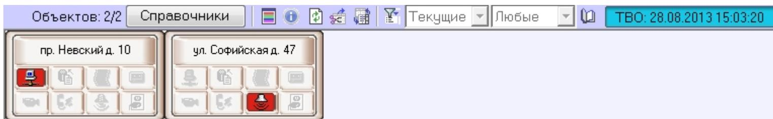
Каждому объекту соответствует графический элемент в виде прямоугольника, внутри которого находится область идентификации объекта (в верхней части) и настраиваемое количество клавиш-индикаторов тревог, сформированных в группы по типу источников:
