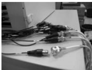
Рис. 3.1—5. Подключение видеокамер к интерфейсному кабелю
