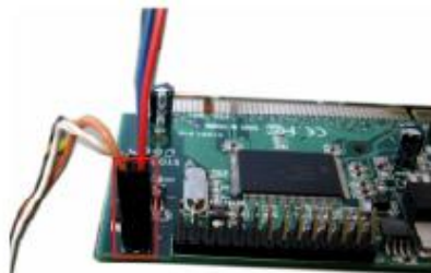
Рис. 3.1—21. Подключение кабеля «WatchDog»
