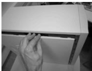
Рис. 3.1—3. Установка крышки корпуса системного блока
