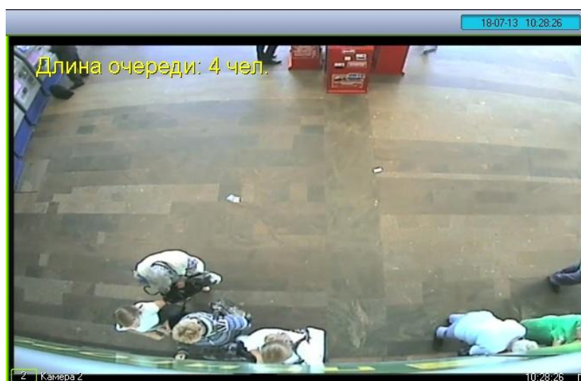
Рис. 7.1—2 Визуализация работы детектора длины очереди
