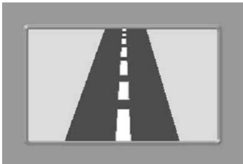
Рис. 6.2.2.2-1 Изображение дороги, соответствующее рекомендуемому расположению видеокамеры
